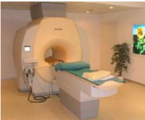
Abb. 1: Moderner 3 Tesla Kernspin-Tomograph im MR-Zentrum des Instituts für Biomedizinische Technik.
